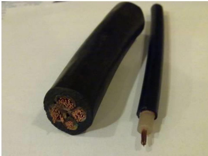
Рис. 2. Образцы проводов линий электропередач (слева для применения в трехфазной системе передачи электроэнергии, справа - в однопроводной резонансной)
